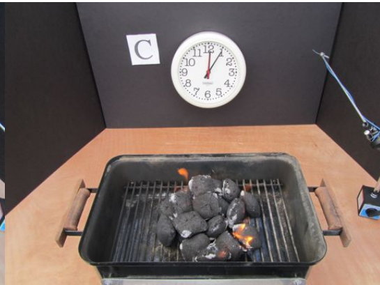
0:05 hr. 8% Ash Briquettes Sparking Strong Odor
